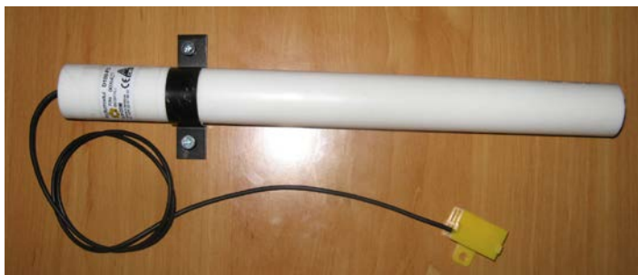
Радиомодули D100-FC-E (диаметр 31 - 33мм, длина 320-330мм )
